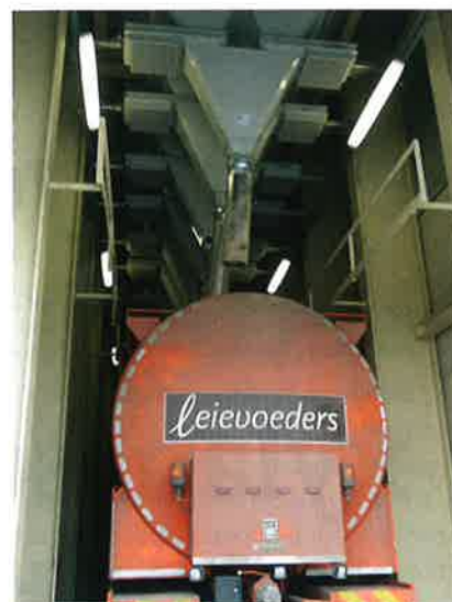
Met de nieuwe laadstraat beschikt Leievoeders over vijf laadstraten met in totaal 68 contrasets voor het laden van bulkwagens.
